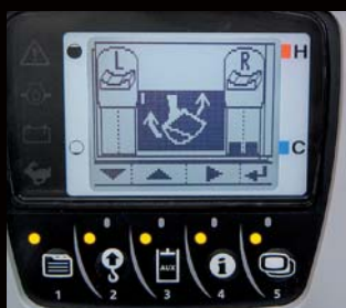
Regolazione del flusso dell'olio (SP1 e SP2)
